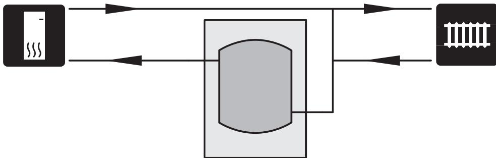
Er wordt een UKV 100 geïnstalleerd als volumeverhoger in die gevallen waarin het systeemvolume in het afgifte-systeem lager is dan het minimaal aanbevolen volume voor de warmtepomp.
