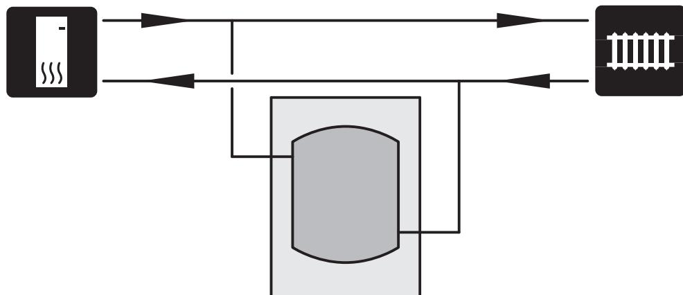
I de fall då systemvolymen i klimatsystemet är under minimum rekommenderad volym för värmepump och/eller flödet stryps okontrollerat installeras en UKV 100 som volym- och flödeshöjare.
