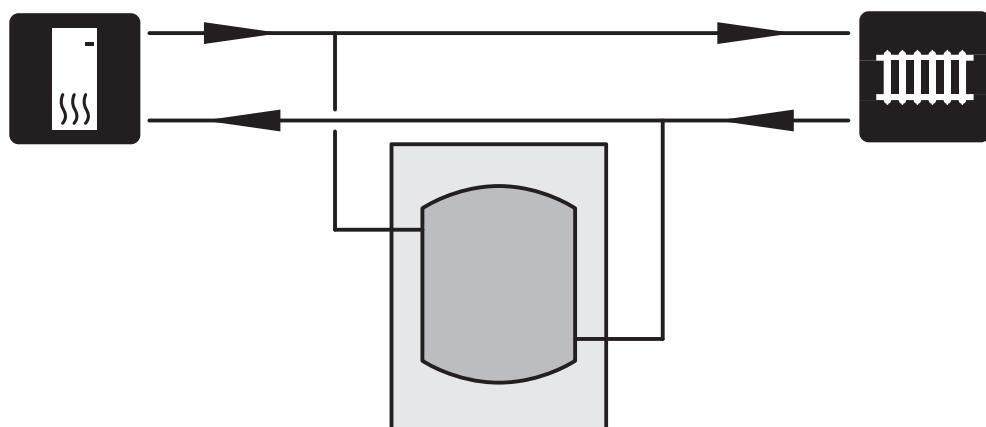
Un UKV 100 este instalat ca amplificator de volum și debit în cazurile în care volumul sistemului din sistemul de climatizare se situează sub volumul minim recomandat pentru pompa de căldură și/sau debitul sunt restricționate fără control.
