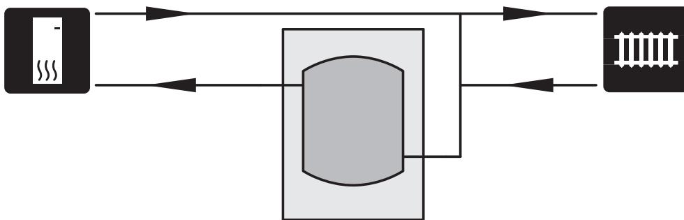
Wenn das Systemvolumen im Klimatisierungssystem unter dem empfohlenen Mindestvolumen für die Wärmepumpe liegt, ist ein UKV 100 zur Volumenstromvergrößerung zu installieren.
