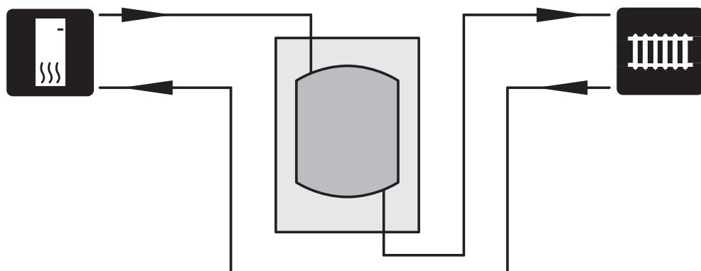
Un UKV 100 este instalat ca amplificator de volum în cazurile în care volumul sistemului de climatizare se situează sub volumul minim recomandat pentru pompa de căldură.
