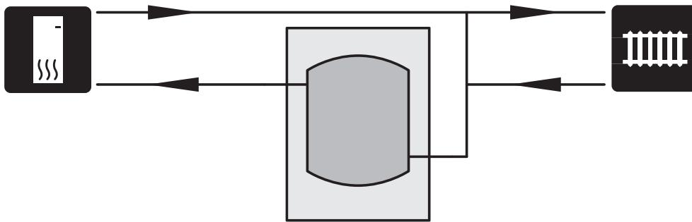
I de fall då systemvolymen i klimatsystemet är under minimum rekommenderad volym för värmepump installeras en UKV 100 som volymhöjare.
