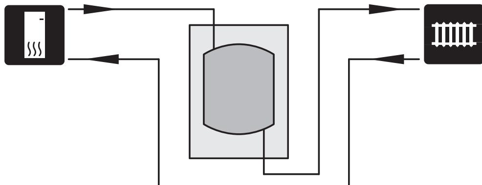
Er wordt een UKV 100 geïnstalleerd als volumeverhoger in die gevallen waarin het systeemvolume in het afgifte-systeem lager is dan het minimaal aanbevolen volume voor de warmtepomp.
