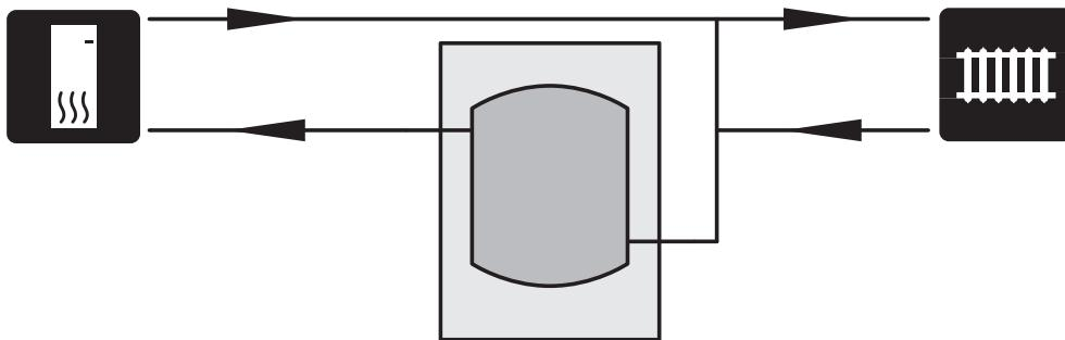
Un UKV 100 este instalat ca amplificator de volum în cazurile în care volumul sistemului de climatizare se situează sub volumul minim recomandat pentru pompa de căldură.
