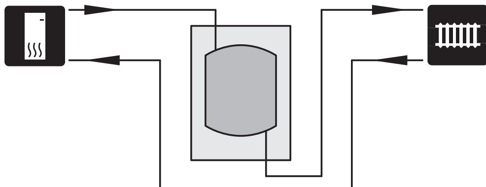
I de fall då systemvolymen i klimatsystemet är under minimum rekommenderad volym för värmepump installeras en UKV 100 som volymhöjare.
