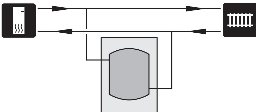
Wenn das Systemvolumen im Klimatisierungssystem unter dem empfohlenen Mindestvolumen für die Wärmepumpe liegt bzw. der Volumenstrom unkontrolliert gedrosselt wird, ist ein UKV 100 zur Volumen- und Durchflussvergrößerung zu installieren.
