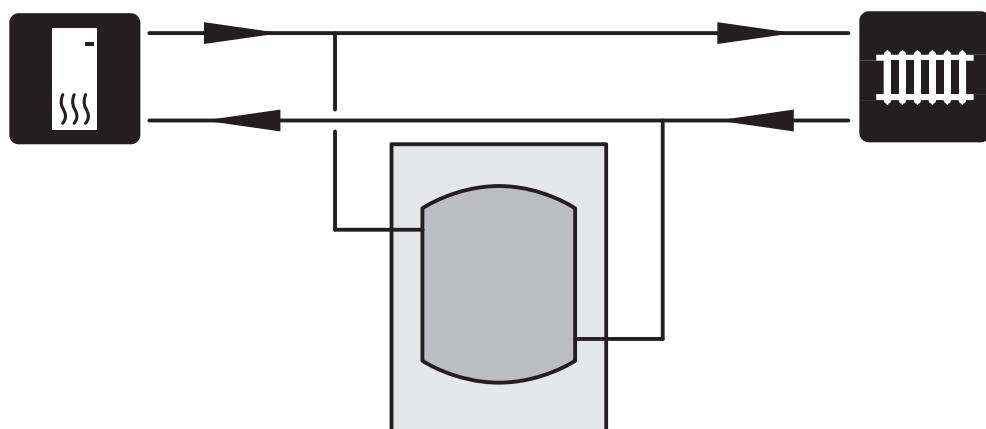
Er wordt een UKV 100 geïnstalleerd als volume- en debietverhoger in die gevallen waarin het systeemvolume in het afgiftesysteem lager is dan het minimaal aanbevolen volume voor de warmtepomp en/of het debiet wordt beperkt zonder controle.
