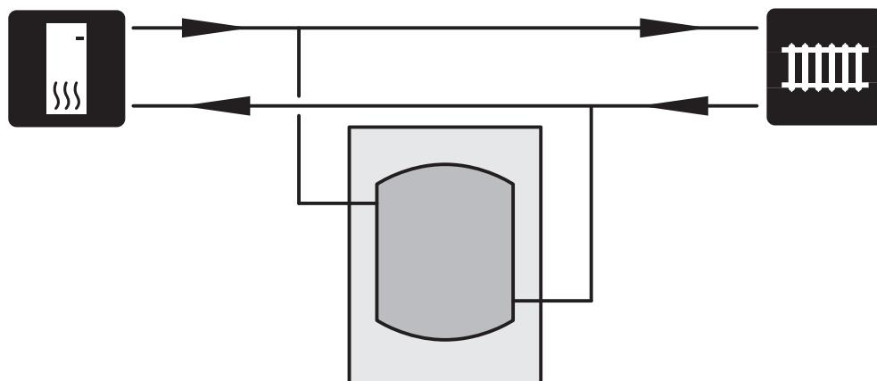
Jos järjestelmän tilavuus on alle lämpöpumpun pienimmän suositellun tilavuuden ja/tai virtausta rajoitetaan hallitsemattomasti, asennetaan UKV 100 tilavuuden ja virtauksen suurentamiseksi.
