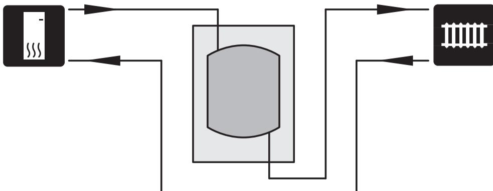
Wenn das Systemvolumen im Klimatisierungssystem unter dem empfohlenen Mindestvolumen für die Wärmepumpe liegt, ist ein UKV 100 zur Volumenstromvergrößerung zu installieren.
