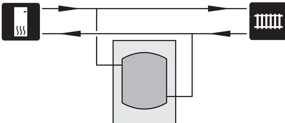
Er wordt een UKV 40 geïnstalleerd als volume- en debietverhoger in die gevallen waarin het systeemvolume in het afgiftesysteem lager is dan het minimaal aanbevolen volume voor de warmtepomp en/of het debiet wordt beperkt zonder controle.
