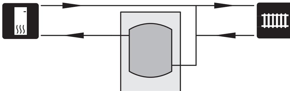
I de fall då systemvolymen i klimatsystemet är under minimum rekommenderad volym för värmepump installeras en UKV 40 som volymhöjare.
