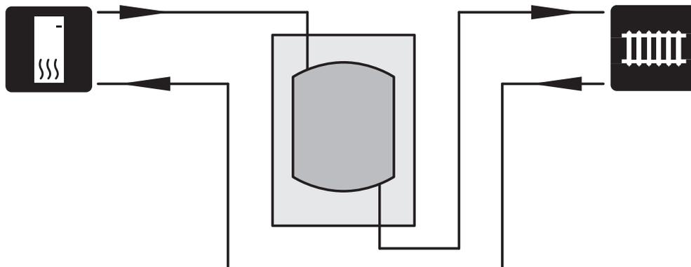
I de fall då systemvolymen i klimatsystemet är under minimum rekommenderad volym för värmepump installeras en UKV 40 som volymhöjare.
