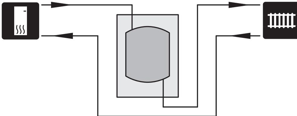
Un UKV 40 este instalat ca amplificator de volum în cazurile în care volumul sistemului de climatizare se situează sub volumul minim recomandat pentru pompa de căldură.
