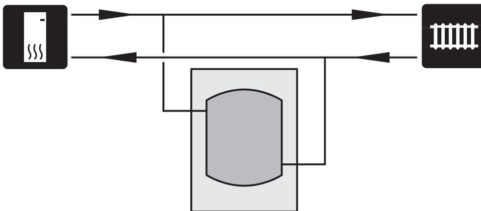
Un UKV 40 este instalat ca amplificator de volum și debit în cazurile în care volumul sistemului din sistemul de climatizare se situează sub volumul minim recomandat pentru pompa de căldură și/sau debitul sunt restricționate fără control.
