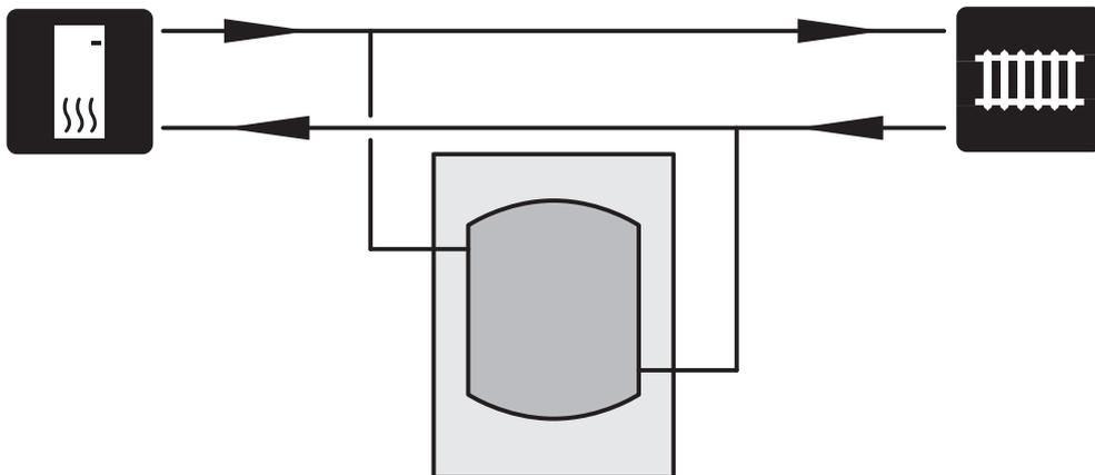
Wenn das Systemvolumen im Klimatisierungssystem unter dem empfohlenen Mindestvolumen für die Wärmepumpe liegt bzw. der Volumenstrom unkontrolliert gedrosselt wird, ist ein UKV 40 zur Volumen- und Durchflussvergrößerung zu installieren.
