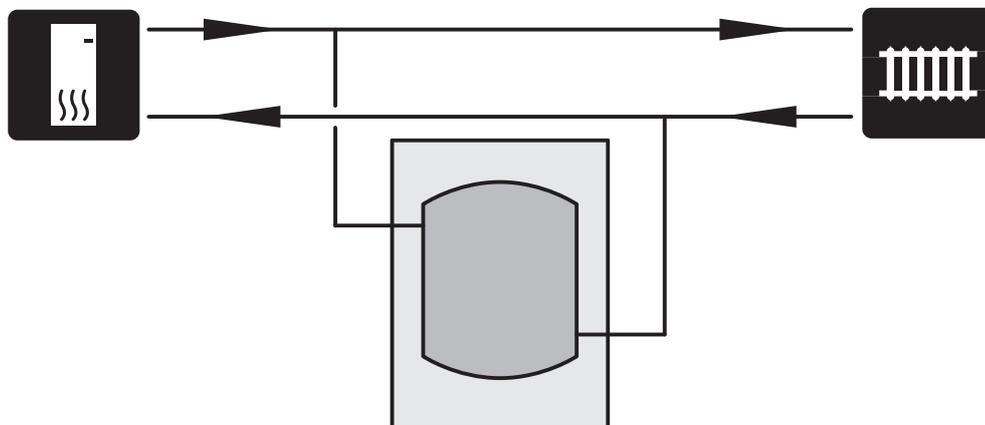
I de fall då systemvolymen i klimatsystemet är under minimum rekommenderad volym för värmepump och/eller flödet stryps okontrollerat installeras en UKV 40 som volym- och flödeshöjare.
