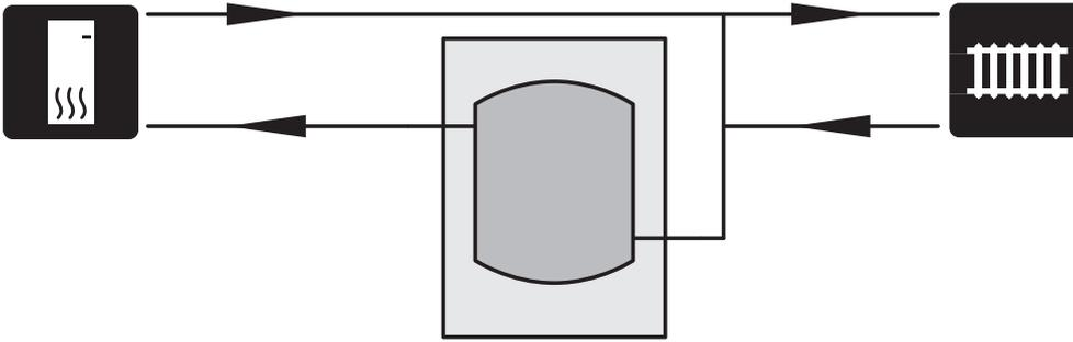
Wenn das Systemvolumen im Klimatisierungssystem unter dem empfohlenen Mindestvolumen für die Wärmepumpe liegt, ist ein UKV 40 zur Volumenstromvergrößerung zu installieren.
