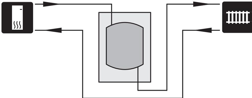
Wenn das Systemvolumen im Klimatisierungssystem unter dem empfohlenen Mindestvolumen für die Wärmepumpe liegt, ist ein UKV 40 zur Volumenstromvergrößerung zu installieren.
