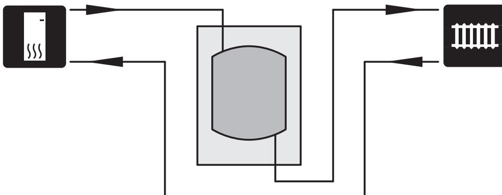
Er wordt een UKV 40 geïnstalleerd als volumeverhoger in die gevallen waarin het systeemvolume in het afgiftesysteem lager is dan het minimaal aanbevolen volume voor de warmtepomp.
